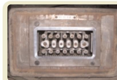
LA "BOCCA" DI UNA FILIERA RIPRODUCE, IN NEGATIVO, LA SEZIONE DEL MATTONE CHE DA ESSA VIENE ESTRUSO
