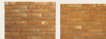
MURETTI CAMPIONE CON DIVERSI SPESSORI DEL GIUNTO ORIZZONTALE
